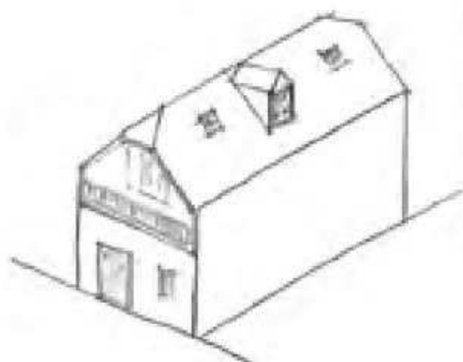
Registre de la lucarne, fenêtres de toit dans l'épaisseur de la couverture, apports de lumière par le traitement du mur pignon.
