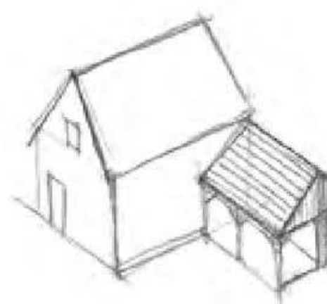
Abri léger orthogonal au bâti principal
