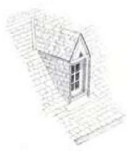
Lucarne en bâtière « jacobine ».
