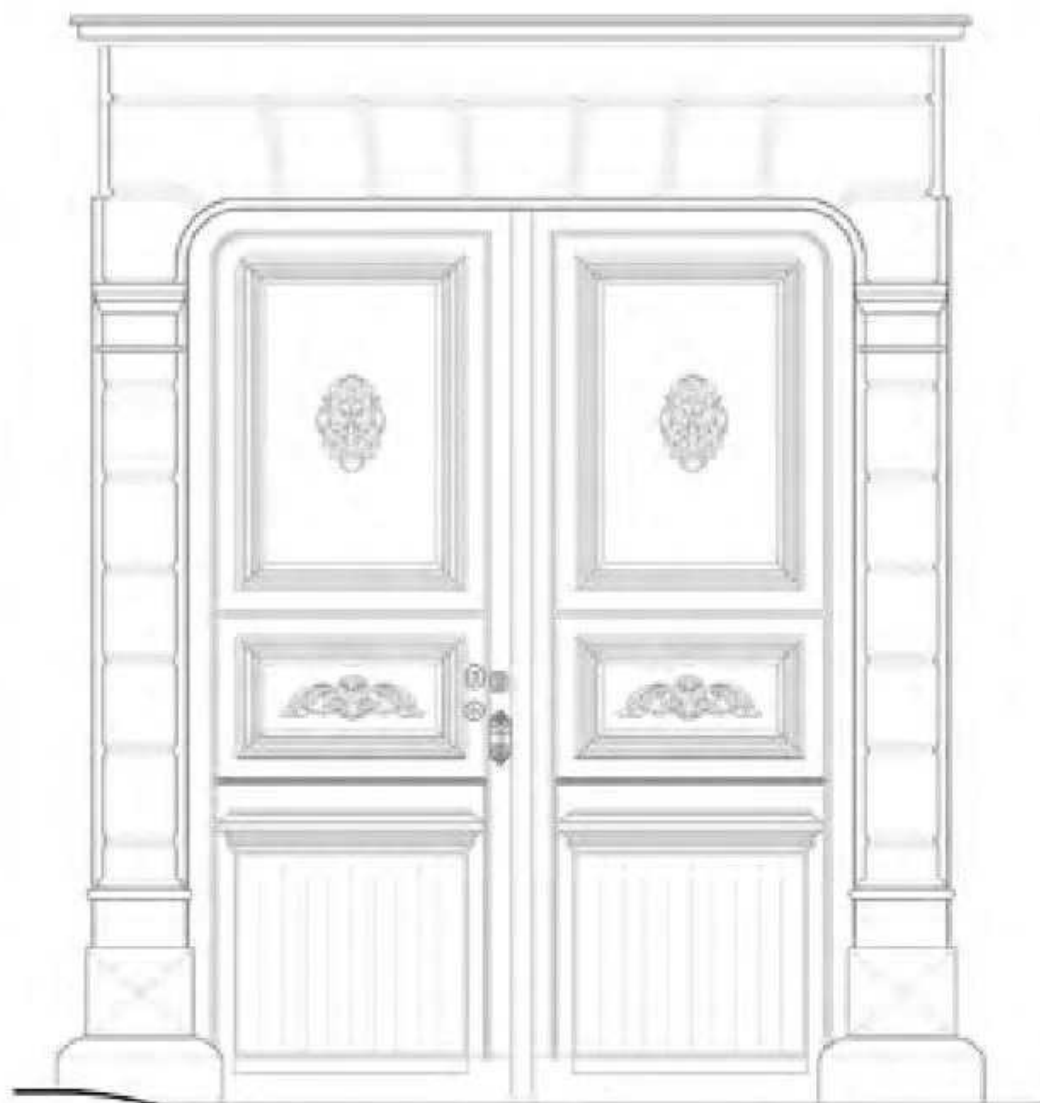
Portail type XIX e siècle, vantail double, menuiserie à panneaux.
